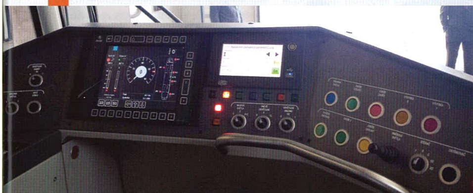
JEDNOTLIVÉ OVLÁDACÍ PRVKY NA ŘÍDÍCÍM PULTU JSOU PŘEHLEDNĚ A ÚČELNĚ USPOŘÁDÁNY. PŘÍMO V ZORNÉM POLI ŘIDIČE JE MULTIFUNKČNÍ GRAFICKÝ DISPLEJ A PALUBNÍ POČÍTAČ.
