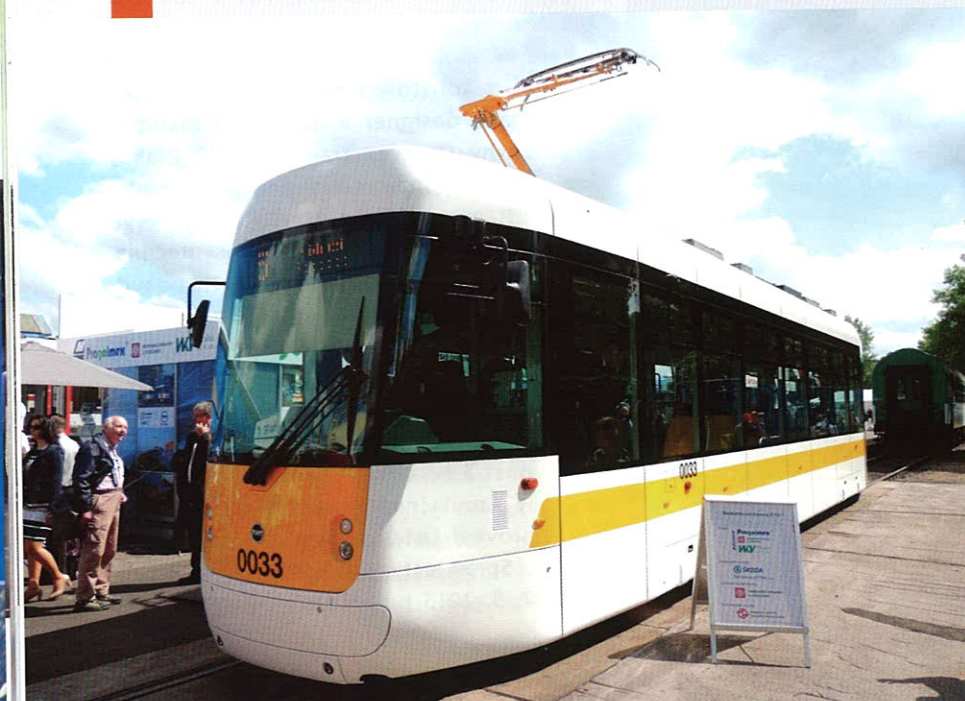
POHLED NA TRAMVAJ EVO1 Z LEVÉ STRANY DOKAZUJE, ŽE KONSTRUKCE VOZOVÉ SKŘÍŇE MÁ SHODNÉ ROZMĚROVÉ MODULY OKEN A DVEŘÍ A TAK LZE POMĚRNĚ SNADNO VYROBIT I OBOUSMĚRNOU VARIANTU. FOTO MARTIN RŮŽIČKA ML.
