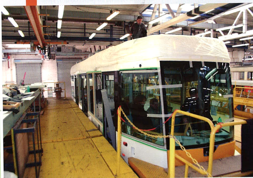
POHLED NA TRAMVAJ EVO1 Z LEVÉ STRANY DOKAZUJE, ŽE KONSTRUKCE VOZOVÉ SKŘÍŇE MÁ SHODNÉ ROZMĚROVÉ MODULY OKEN A DVEŘÍ A TAK LZE POMĚRNĚ SNADNO VYROBIT I OBOUSMĚRNOU VARIANTU. FOTO MARTIN RŮŽIČKA ML.
