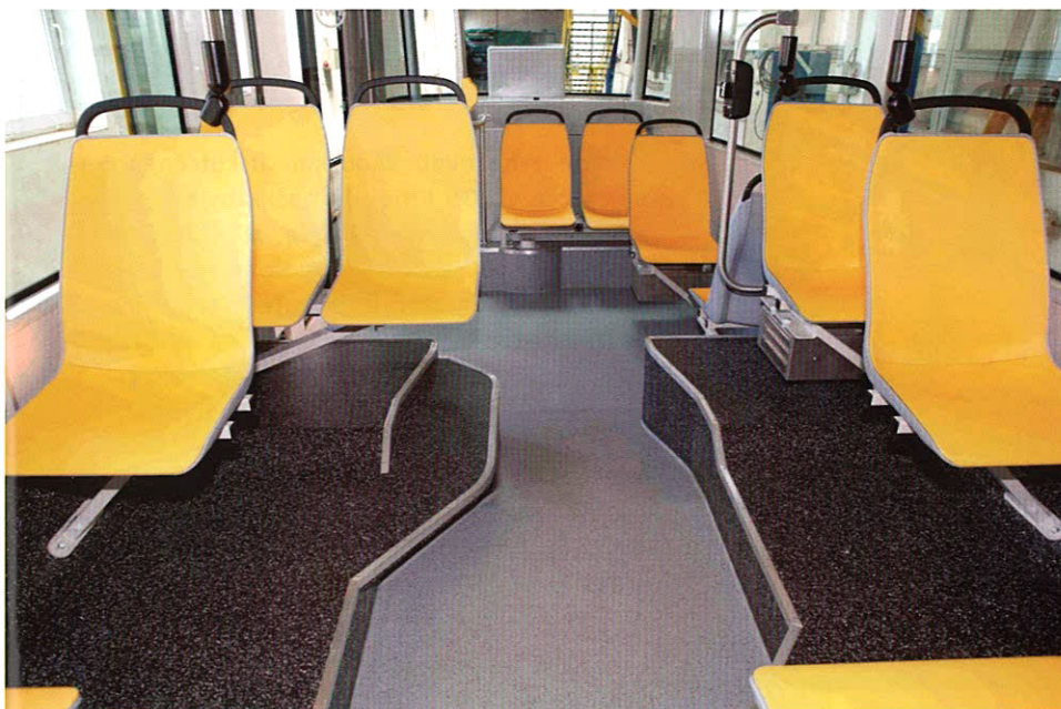
INTERIÉR TRAMVAJE EVO1 JE VYBAVEN MODERNÍMI KVALITNÍMI SEDAČKAMI. NA PODLAZE JE POLOŽENA PROTISKLUZOVÁ KRYTINA ALTRO. TYP SEDAČEK I PODLAHOVINU LZE MĚNIT PODLE VOLBY ZÁKAZNÍKŮ.
